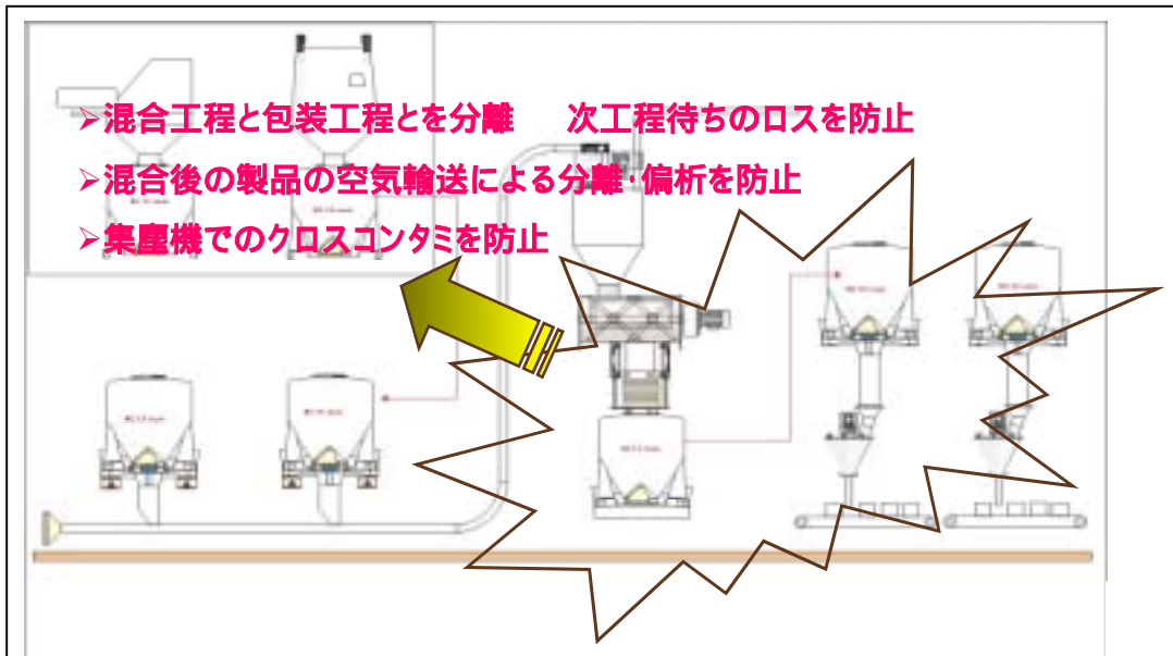
Upgrade 3 : 混合後中間製品を I B C に保管
