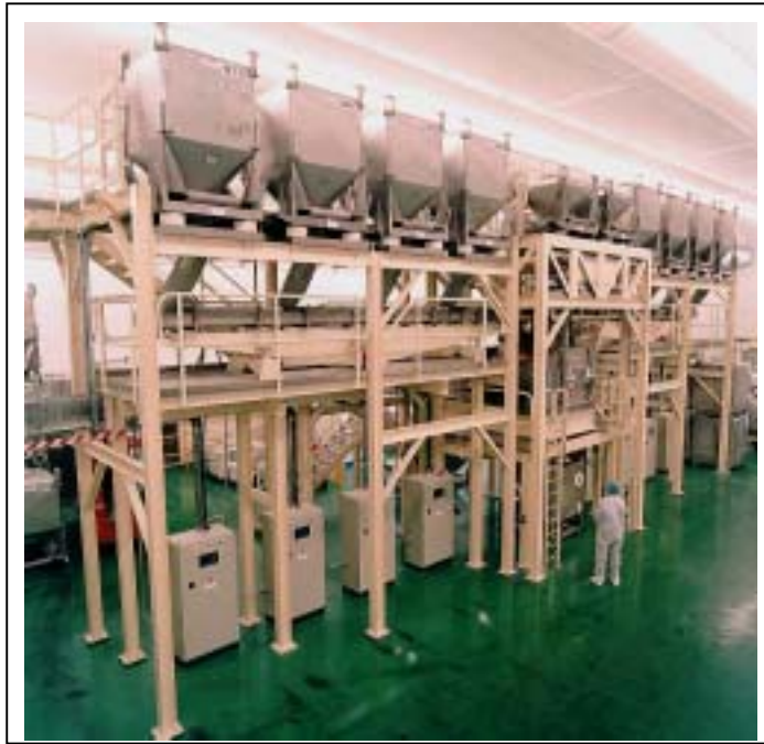
写真1 ミキサーに直接全原料をIBCで配合する場合の実際の写真
